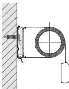
Il s'agit d'un enroulement, dans lequel la toile est éloignée du vitrage. Cet enroulement pourra être utile pour éviter une poignée de fenêtre.
